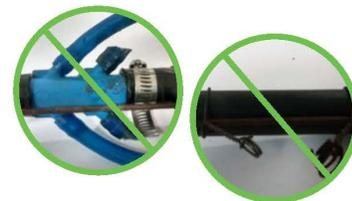
2. Séparer les tuyaux maîtres des tubes de dimension 5/16. Les raccords et chalumeaux en plastique connectés à la tubulure sont acceptés.
